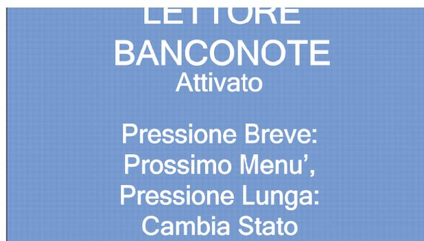
Premere brevemente per accedere al menù successivo. Premere a lungo per cambiare lo stato del lettore da Attivato a Disattivato (o viceversa).
