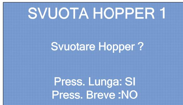
Premere a lungo il tasto di selezione per avviare la procedura di svuotamento automatico dell'hopper, altrimenti premere brevemente il tasto per passare alla schermata successiva.
