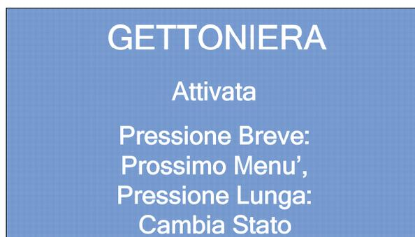
Premere brevemente per accedere al menù successivo. Premere a lungo per cambiare lo stato della gettoniera da Attivata a Disattivata e viceversa.
